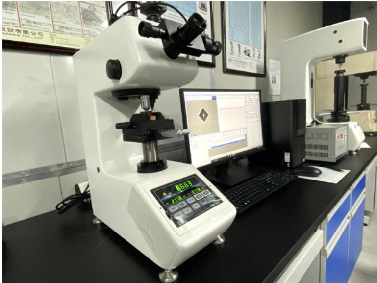
显微硬度计本身会产生两种误差：一是其零件的变形、移动造成的误差；二是硬度参数超出规定标准所造成的误差。对种误差，在测量前需用标准块对硬度计进行校准。对洛氏硬度计校正结果，差值在±1之内合格。差值在±2之内的稳定数值，可以给出修正值。差值在±2范围之外时则必需对硬度计进行校正维修或换其他硬度测试法测定。洛氏硬度各标度有一事实上的适用范围，要根据规定正确选用。例如，硬度高于HRB100时，应采用HRC标度进行测试；硬度低于HRC20时应用HRB标度进行测试。因为超出其规定的测试范围时，硬度计的度及灵敏度较差，硬度值不准确，不宜使用。其他硬度测试法也都规定有相应的校正标准。显微硬度计是反映材料弹性和塑性变形特性指标的重要机械性能指标。无锡HV显微硬度计标注方法
