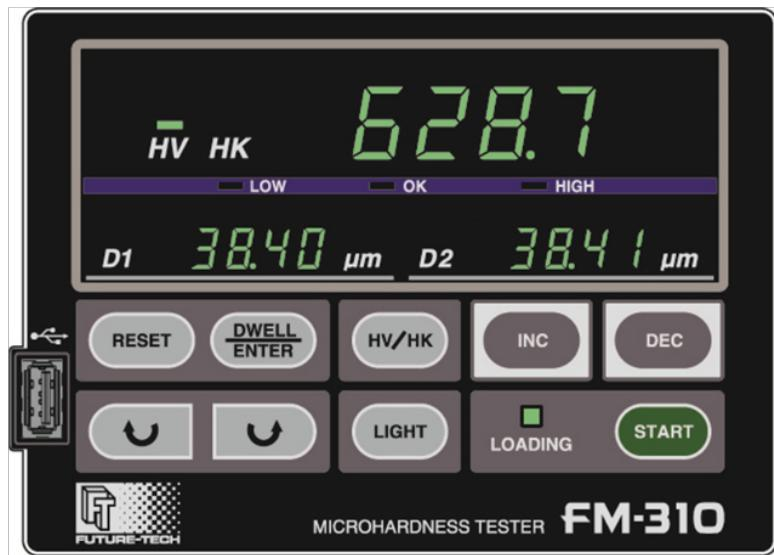
显微硬度计周围环境的影响:工厂生产用硬度计常会因周围环境受震动的影响,致使仪器结构产生松动,示值不稳定。硬度计应安装在无震动或离震源较远的地方。硬度值不准确:有二种情况导致测试硬度不准确,如果所用的压头是金钢石压头,首先用指甲表面轻轻与压头顶部磨擦一二下,观察指甲有没划出深痕迹,有深痕迹表示压头已损坏,反之为好的压头。第二种情况就是仪器微调处未调好,打开硬度计顶盖,用一字螺丝刀把顶针部二颗螺丝调松,然后把微调铁块向前调节使硬度值调高,反之为调低。
